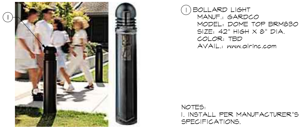
4 42" HT. BOLLARD LIGHT SCALE: N.T.S. 1/1 DT-LightBollard01.dwg
